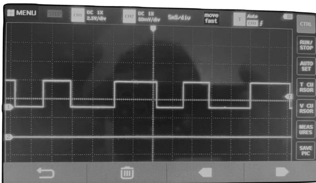
**Рис. 6. Реализация изменяющегося ШИМ сигнала на процессоре STM32RET6**
