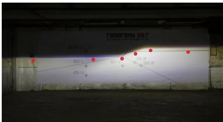
**Рис. 5. Светотеневая граница линзованой фарой
