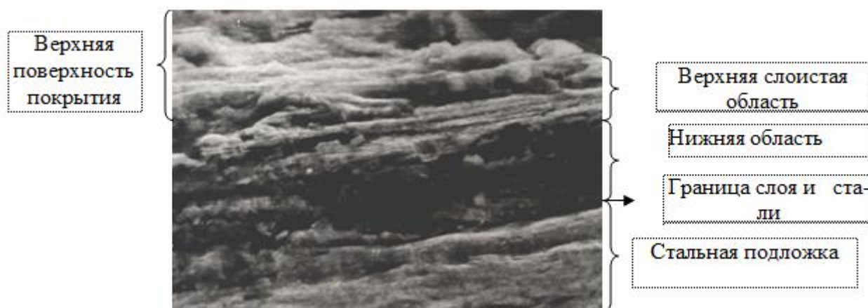
Рис. 2. Результаты сканирующей электронной микроскопии при ускоряющем напряжении 15 кВ и увеличении x3000
