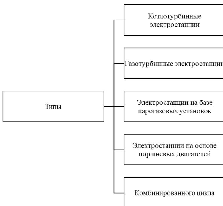
Рис. 1. Типы теплоэлектростанций [3, с. 56]
