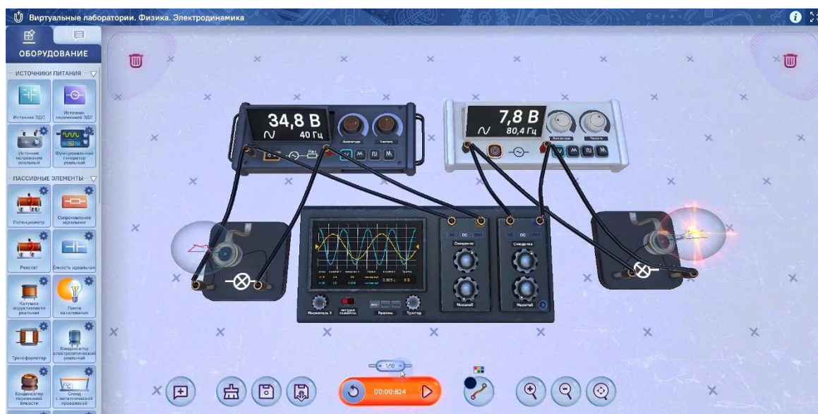
Рис. 2. Пример виртуальной лаборатории по дисциплине «Электродинамика»
