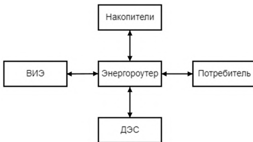
Рис. 2. Схема взаимодействия энергороутера
