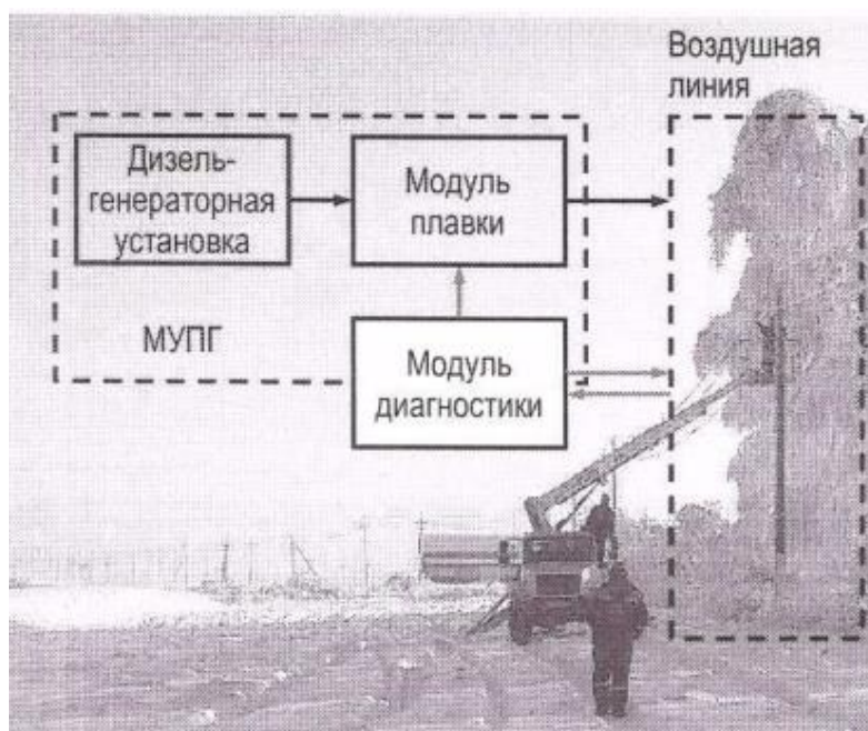
Рис. 1. Оснащение мобильной установки плавки гололёда (МУПГ) модулем диагностики
