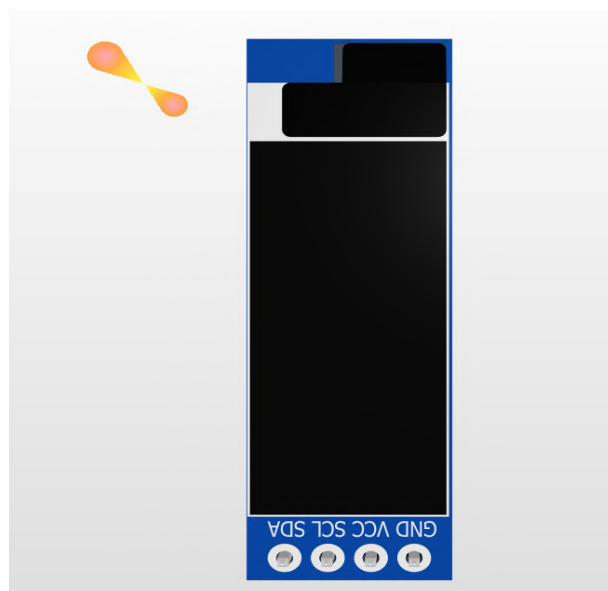
Рис. 4. 3D-модель модуля OLED в программе сквозного проектирования Altium Designer
