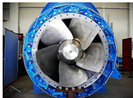
Рис. 3. Конструкция вертикальной пропеллерной турбины
