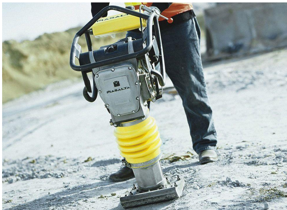
Рис. 4. Виброударный трамбовщик марки Masalta
