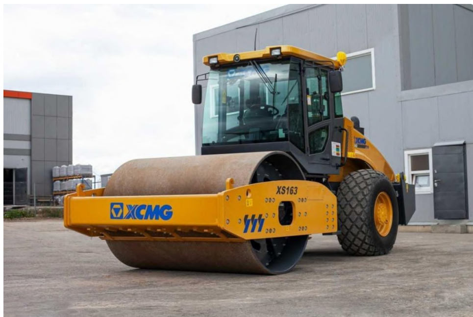
Рис. 2. Грунтовый виброкаток XCMG
