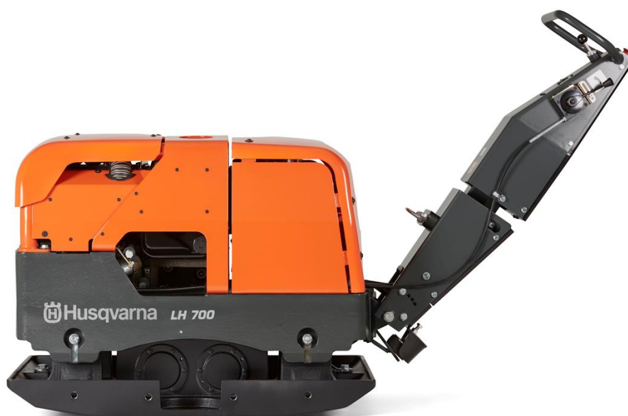
Рис. 3. Виброплита марки Husqvarna
