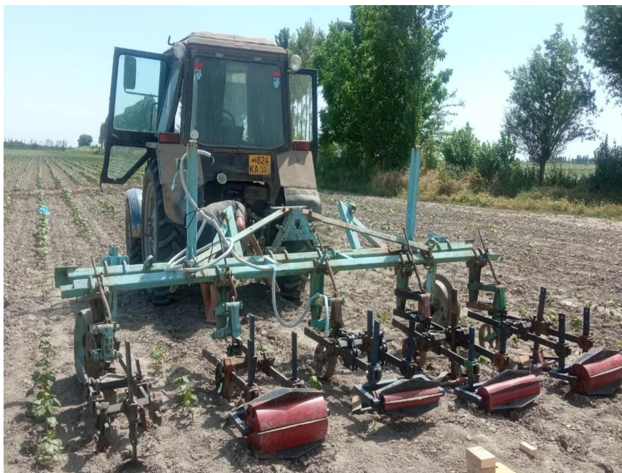
Рис. 2. Общий вид лабораторно-полевой установки при исследовании различных схем размещения плоскорезущих лап и ротационных рабочих органов
