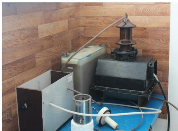
**Рис. 1. Ячейка для обработки нефти и нефтепродуктов**
