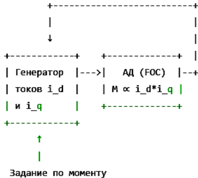
Рис. 2. Структура управления с псевдопоследовательным возбуждением
