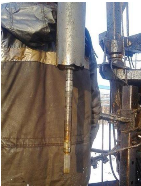
Рис. 2. Разрушение корпуса УЭЦН в месте установки газосепаратора
