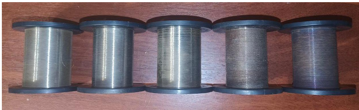
Рис. 2. Экспериментальные результаты никелирования проволоки
