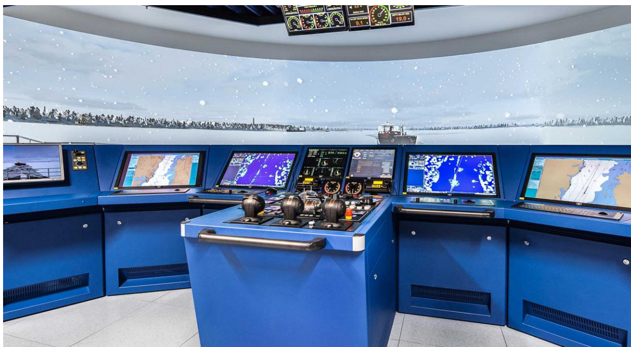
Рис. 3. Вид современного навигационного тренажера маневрирования и управления судном
