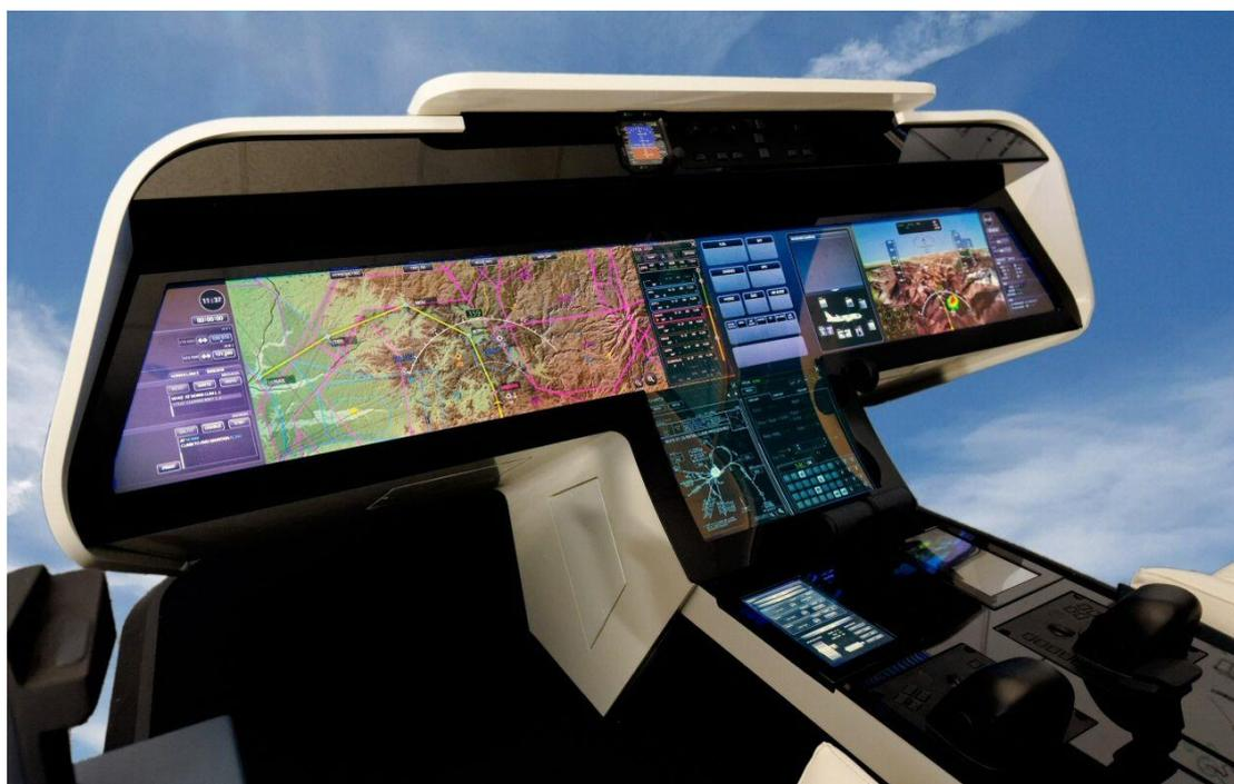
**Рис. 2. Приборная доска с единой зоной индикации и управления на ЖК-матрице с сенсорным экраном**
