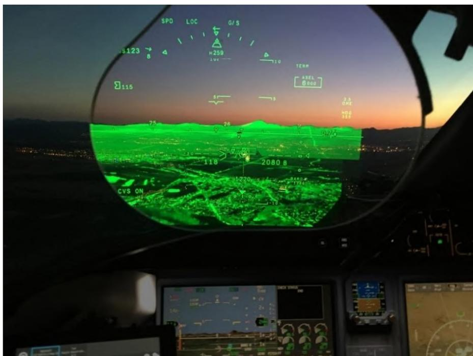
**Рис. 4. Изображение от системы ИК-системы улучшенного видения на индикаторе на лобовом стекле**
