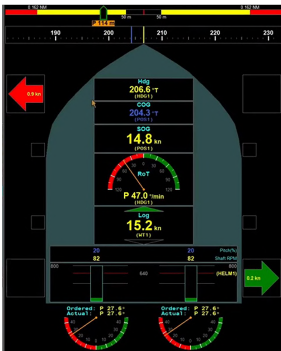
Рис. 3. Пример численного отображения данных о кинематических параметрах движения судна на многофункциональном дисплее OSI Marine Systems
