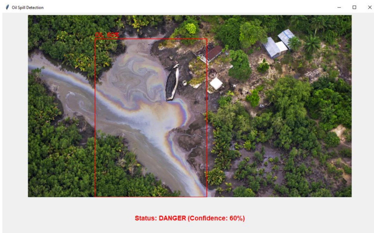
Рис. 12. Пример реакции модели на масляные пятна в гуще леса
