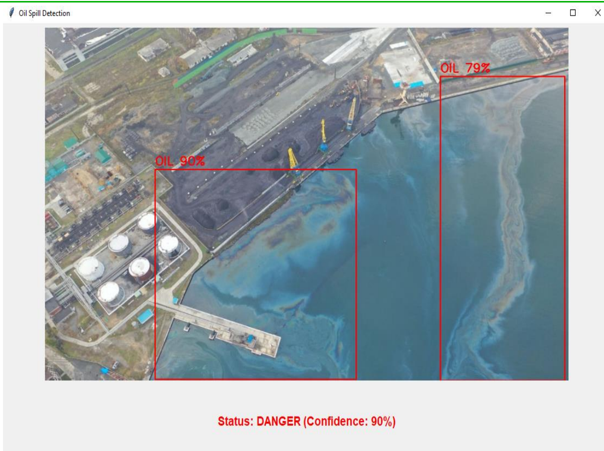
Рис. 13. Пример реакции модели на утечки в воду с промышленного объекта
