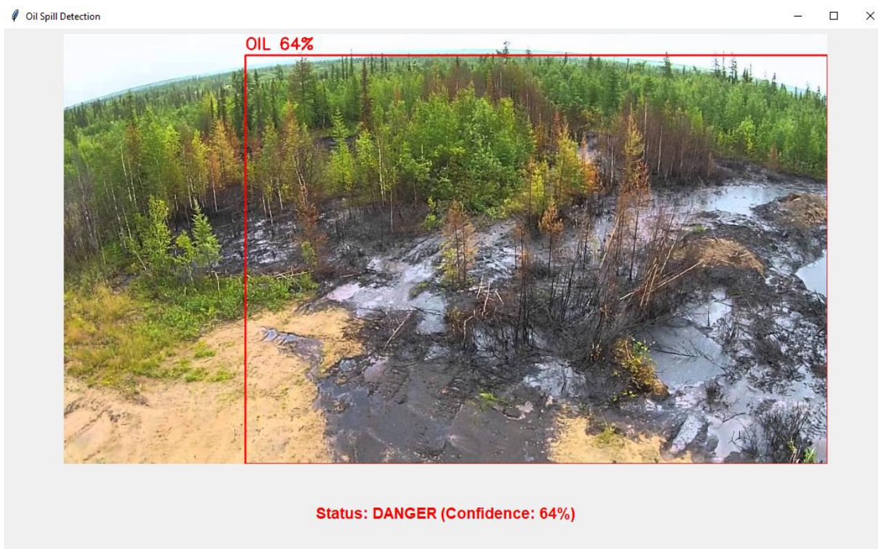
Рис. 11. Пример реакции модели на нефть, растекшейся по земле в лесу
