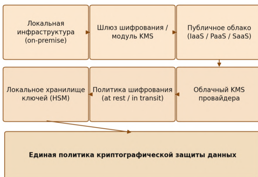
Рис. 1. Архитектура управления криптографическими ключами в гибридной облачной среде
