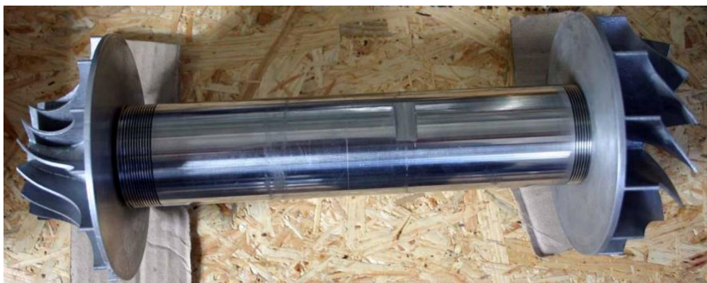
Рис. 4. Ротор турбодетандерного агрегата, включающий в себя рабочие колеса компрессора и детандера [7]
