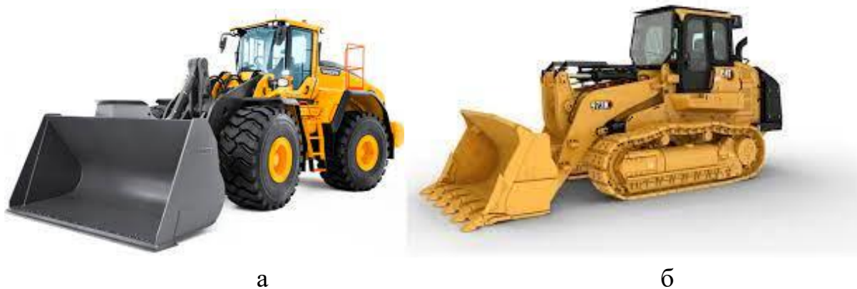
Рис. 1. Фронтальный погрузчик: а - фронтальных погрузчиков колёсного вида, б - гусеничные погрузчики
