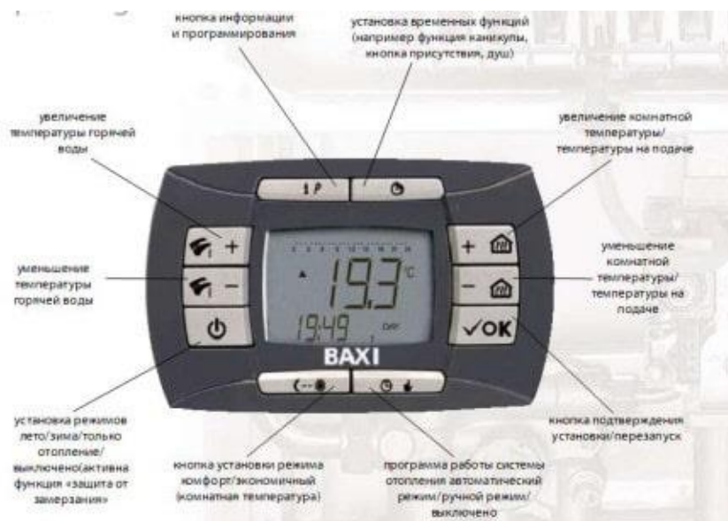
Рис. 3. Панель управления электрическим котлом
