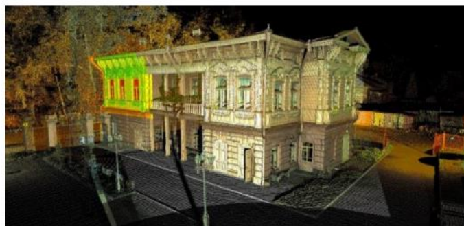
Рис. 2. Выделение проблемной области при наземном лазерном сканировании
