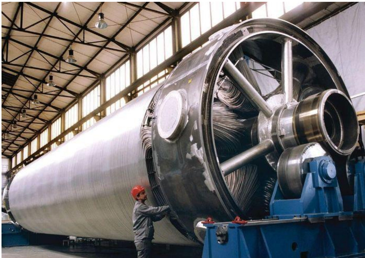
Рис. 2. Пример технического устройства витого теплообменника
