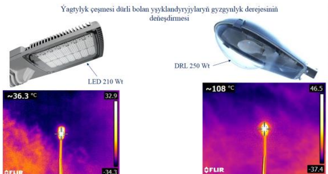
Рис. 2. Сравнение температуры ламп с разными источниками света
