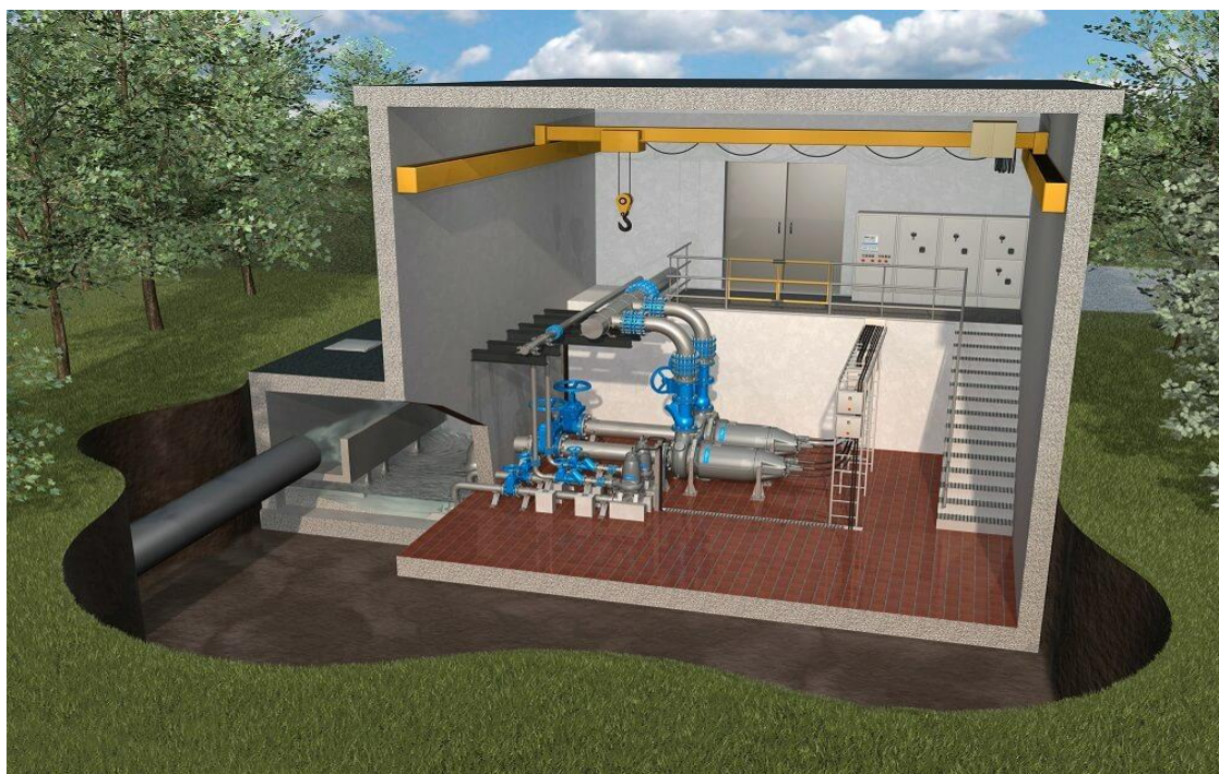
Рис. 1. Канализационная насосная станция
