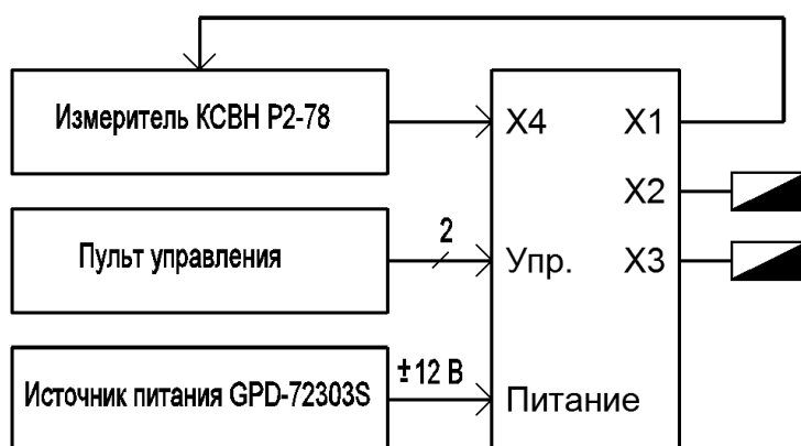
Рис. 2. Схема измерений КВСН и ослабления
