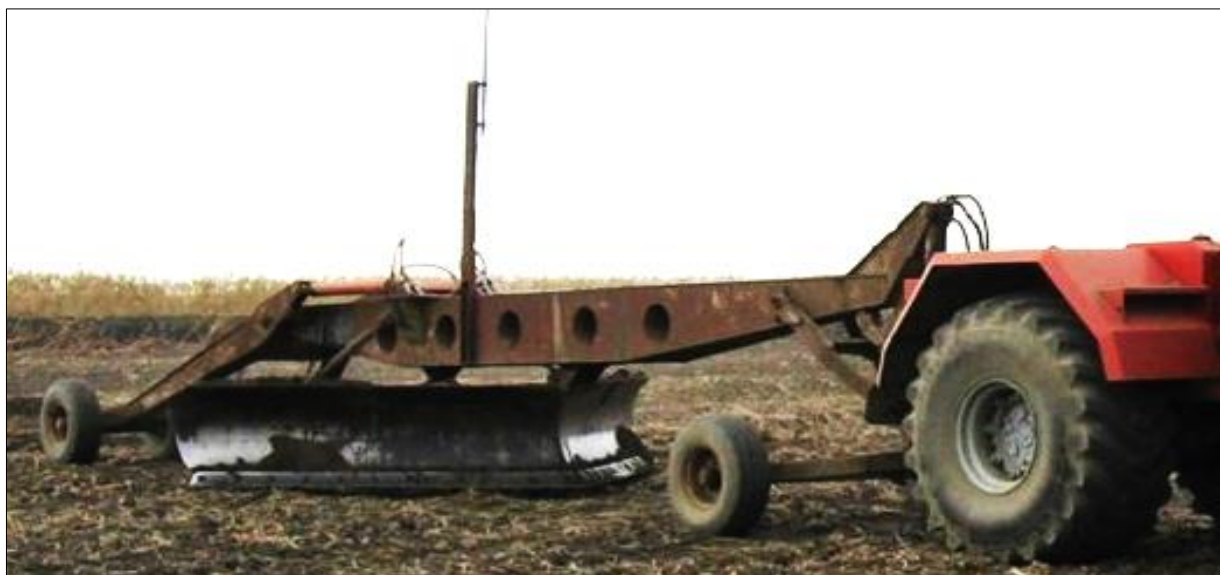
Рис. 2. Прицепной клин-планировщик марки КП-719 с лазерным управлением
