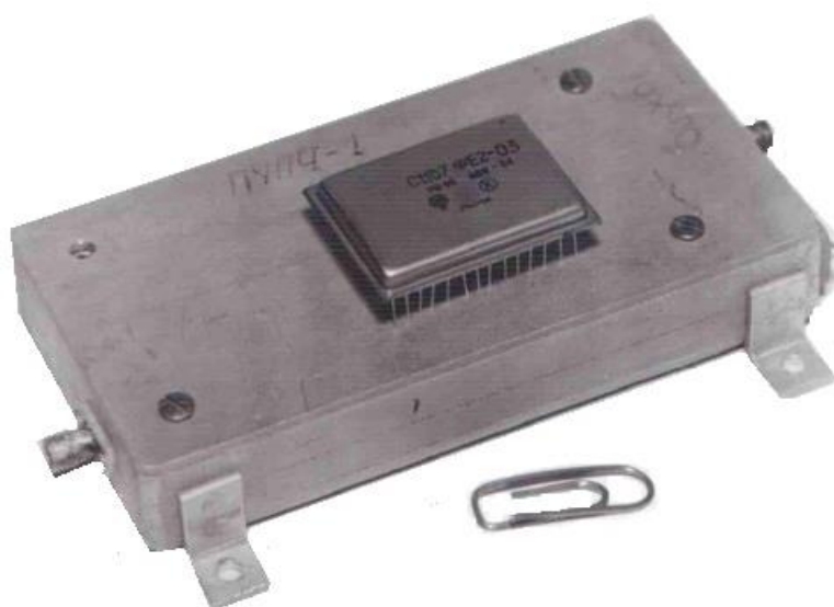
Рис. 3. Фильтр на ПАВ и УПЧ на его основе
