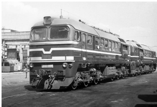
Рис. 1. Тепловоз СССР серии 2М62
