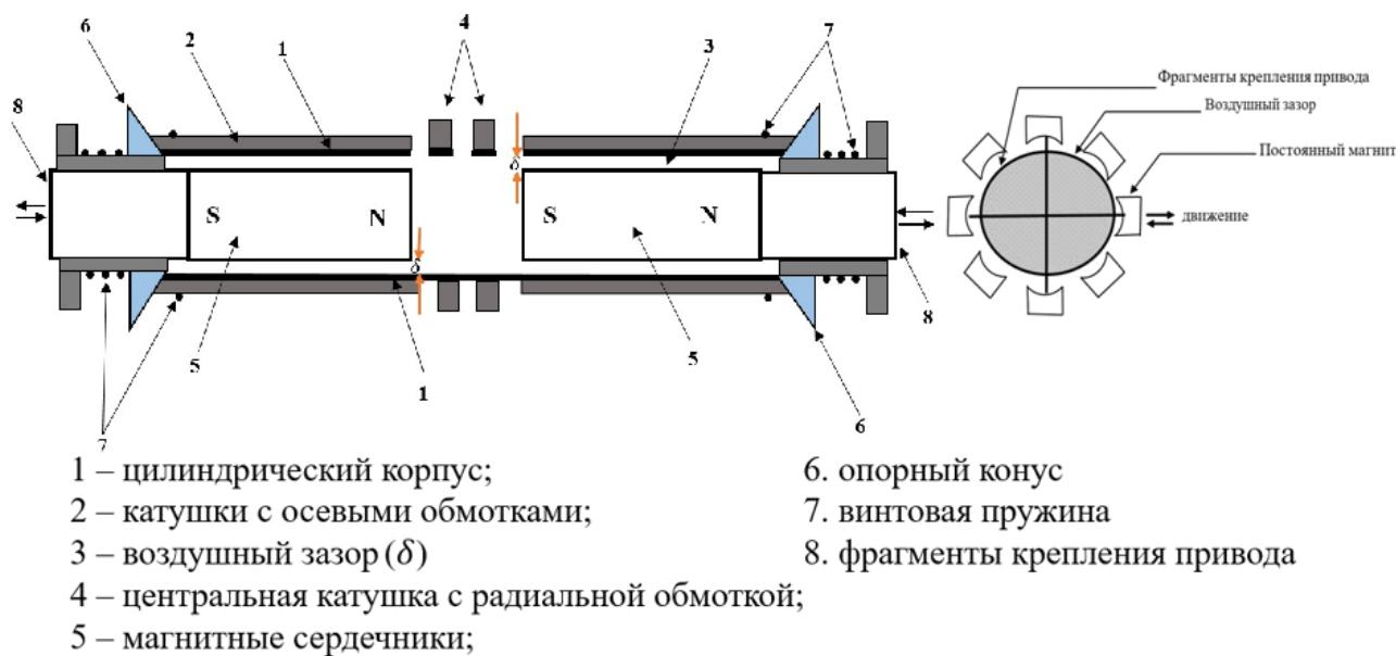
**Рис. 1. Линейный электрический генератор с электромагнитным регулятором воздушного зазора**
