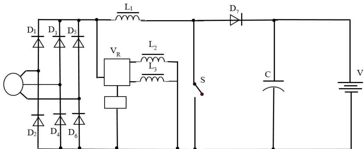
**Рис. 2. Схема подключения ВМГ с электромагнитным регулятором воздушного зазора**
