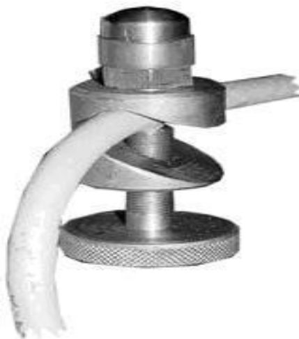
Рис. 8. Установка виброакселерометра на ТИВД
