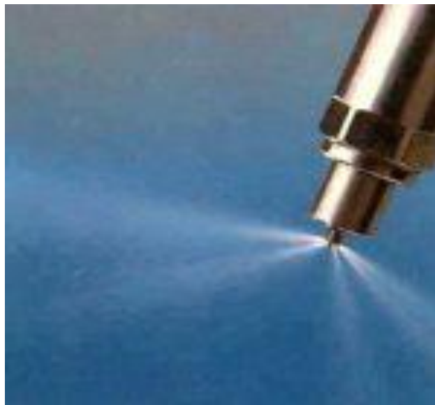
Рис. 5. Качественное распыление топлива форсункой
