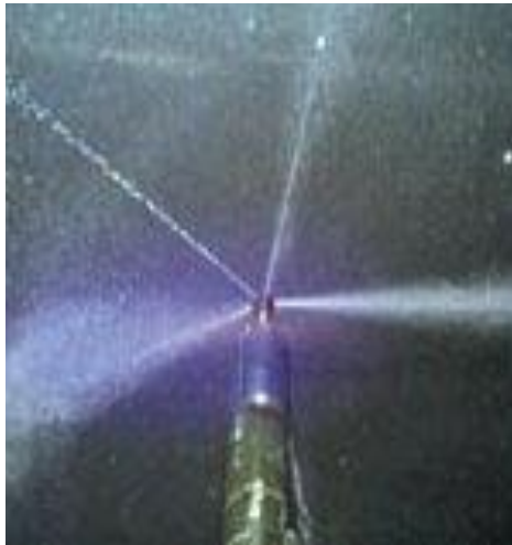
Рис. 6. Не качественное распыление топлива форсункой
