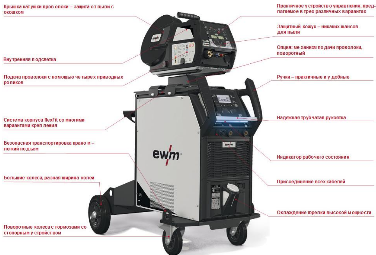
Рис. 4. Общий вид сварочного источника Titan XQ R 400 Puls DWEG
