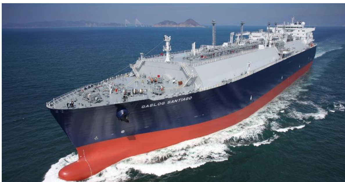
Рис. 2. Танкер-газовоз с мембранными танками
