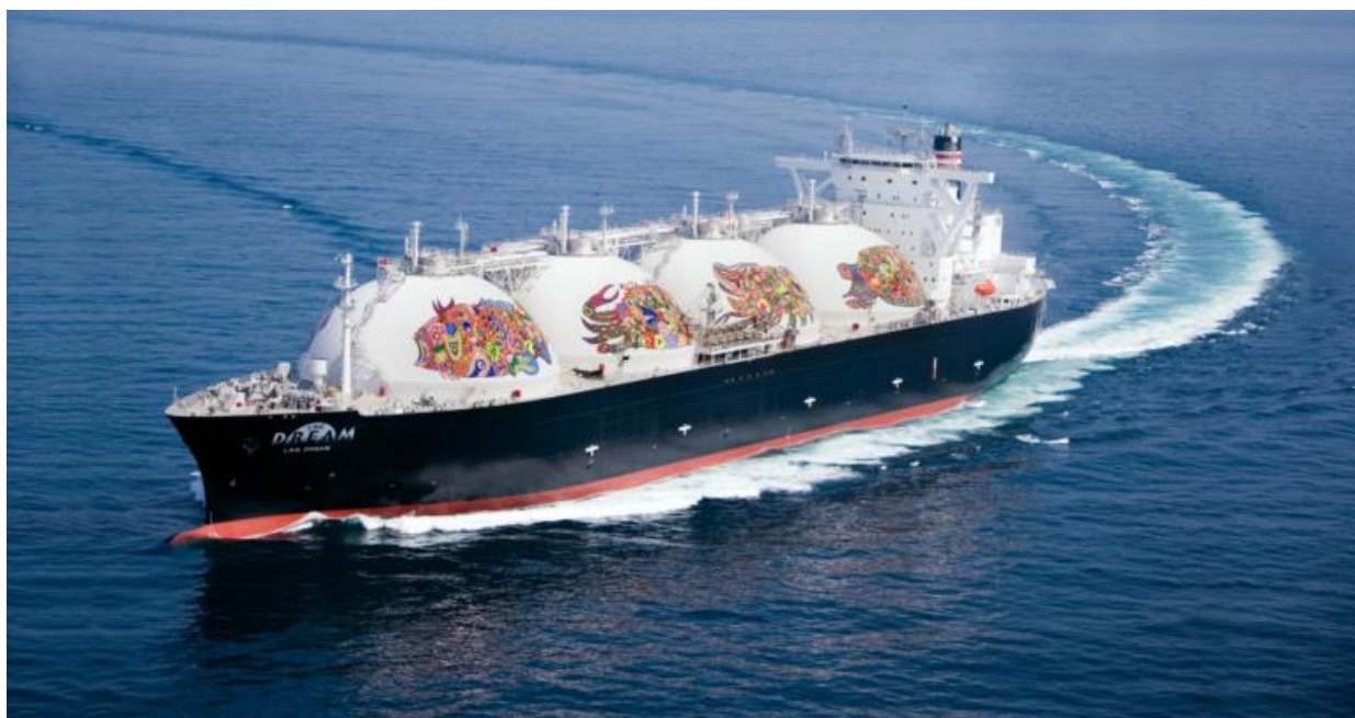
Рис. 1. Танкер-газовоз с танками типа MOSS
