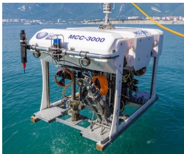
Рис. 6. Телеуправляемый необитаемый подводный аппарат MCC-3000
