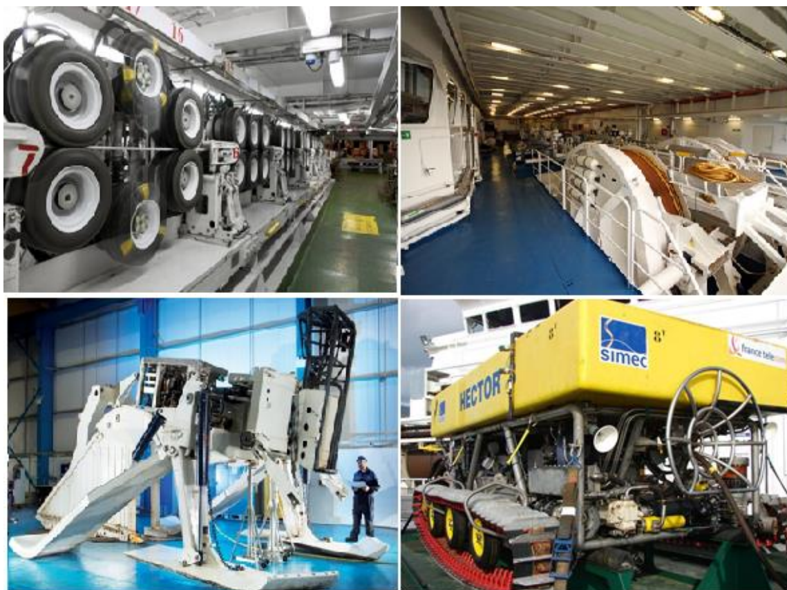
Рис. 5. Оборудование судов кабелеукладчиков сверху слева - линейная кабельная машина, сверху справа - барабанная кабельная машина, снизу слева – Плуг (Emma MD3 C0688) снизу справа – Траншекопатель (HECTOR)
