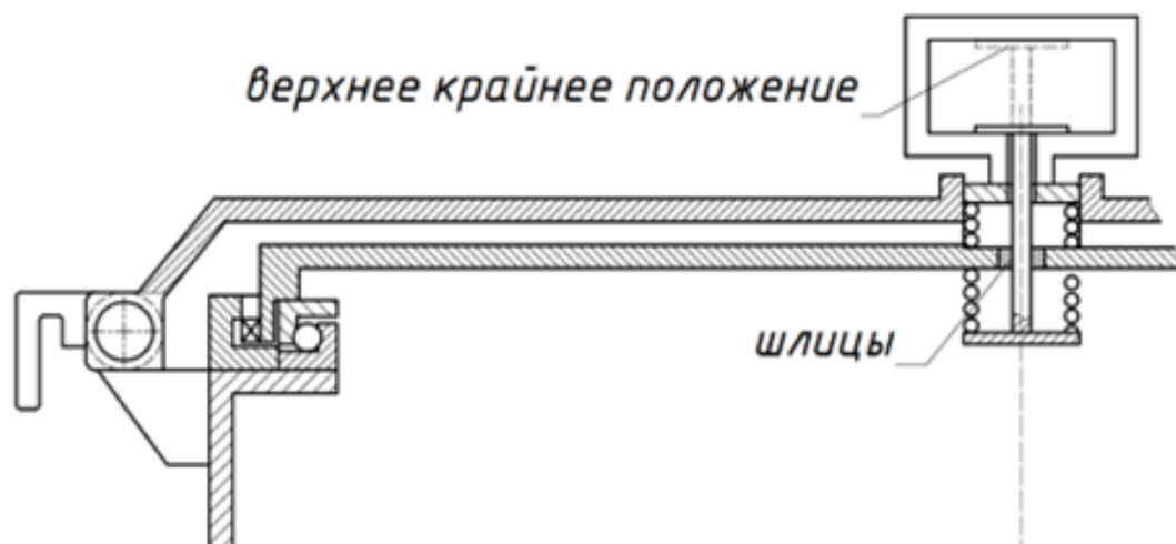
Рис. 12. Центрирование осуществляется по наружному диаметру, второй вариант сборки
