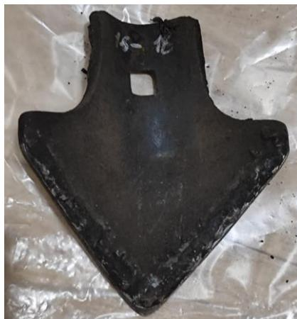
**Рис. 6. Наплавка упрочняющей сплошной полосы снизу (6 схема)**
