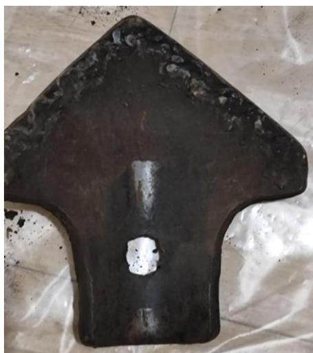
**Рис. 8. Наплавка упрочняющей полосы
