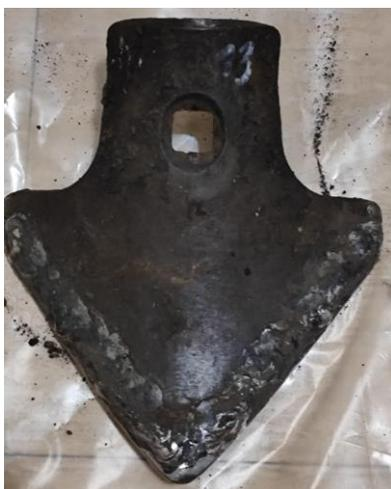
**Рис. 5. Наплавка упрочняющей сплошной полосы сверху (5 схема)**
