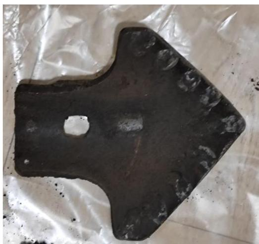
**Рис. 3. Наплавка упрочняющих полос на крыльях и носке снизу (3 схема)**
