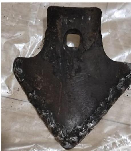
**Рис. 7. Наплавка упрочняющей полосы
