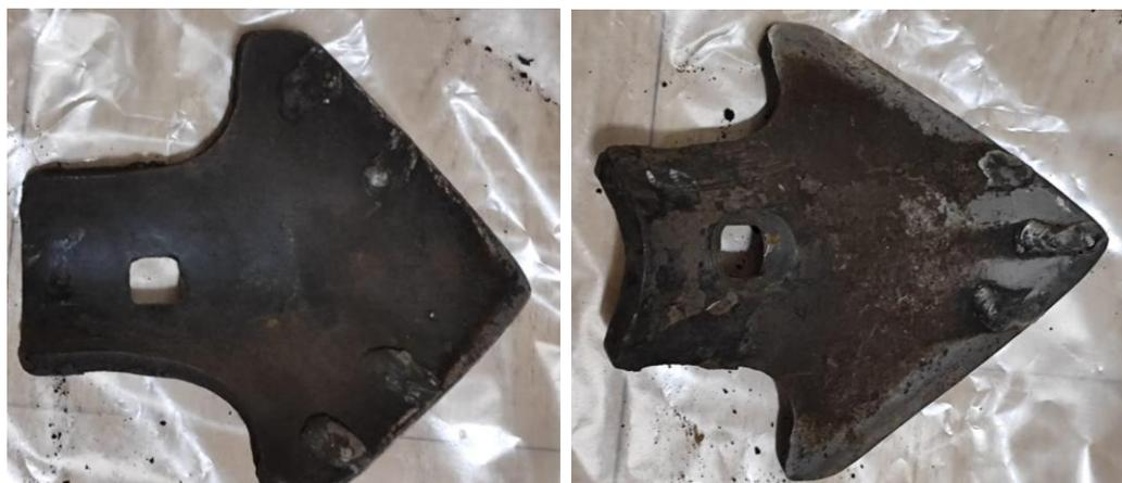
**Рис. 2. Наплавка упрочняющих полос на крыльях снизу, на носке сверху, расстояние между полосками 15 мм (2 схема)**
