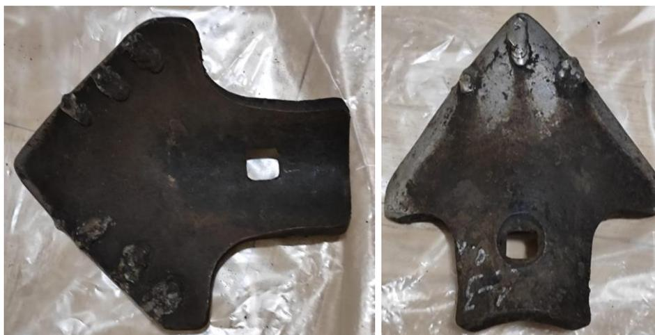
**Рис. 1. Наплавка упрочняющих полос на крыльях снизу, на носке сверху, расстояние между полосками 10 мм (1 схема)**
