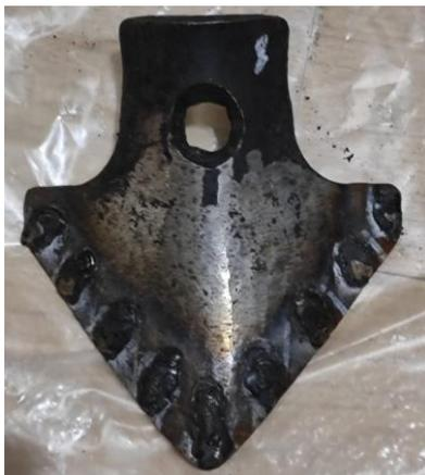
**Рис. 4. Наплавка упрочняющих полос на крыльях и носке сверху (4 схема)**
