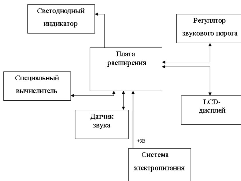
Рис. 2. Структурная схема канала оценки звука
