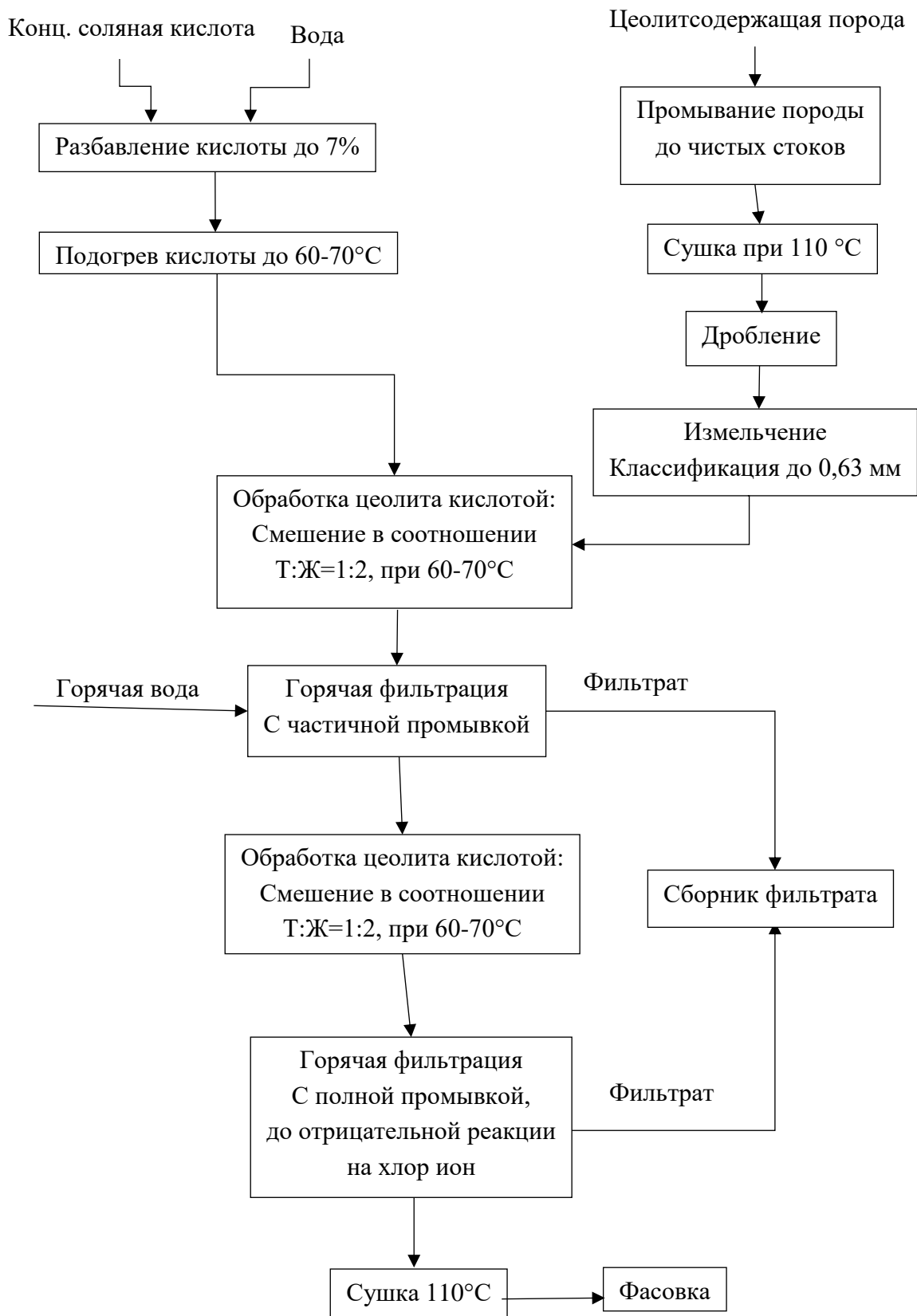
Рис. 1. Блок- схема «Химическая активация цеолита под воздействием соляной кислоты»
