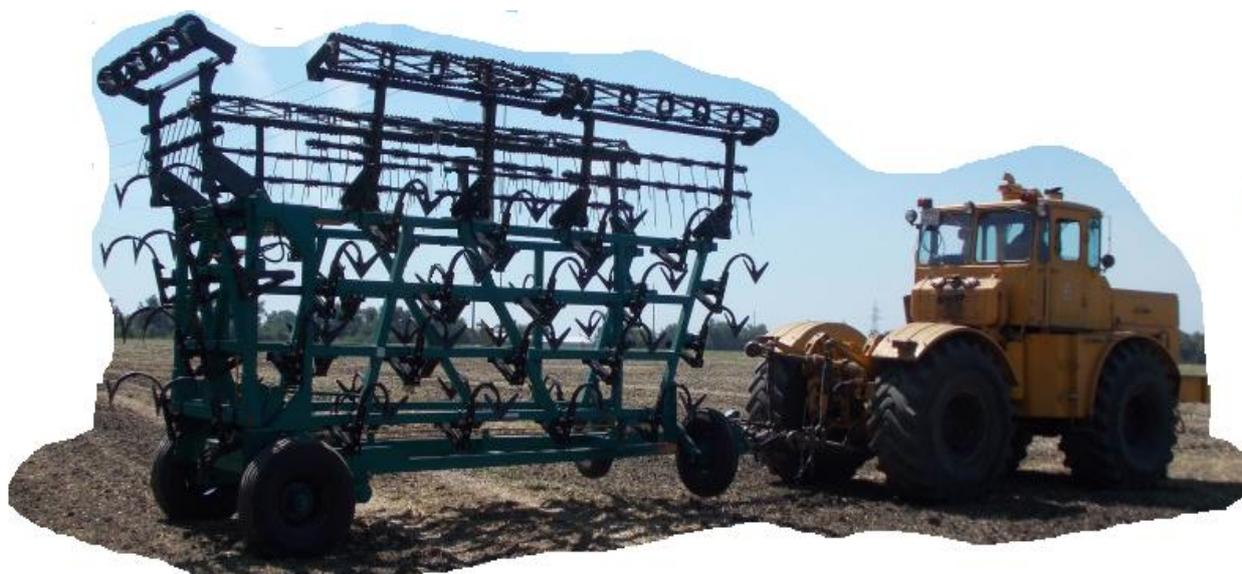
**Рис. 2. Культиватор КСОП-12 продольно-поперечной схемой складывания рамы [11]**
