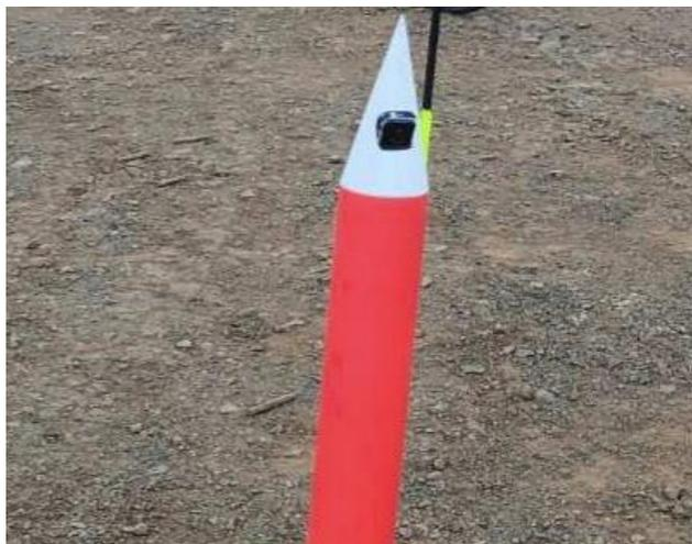
**Рис. 6. Камера в носовой части ракеты**
