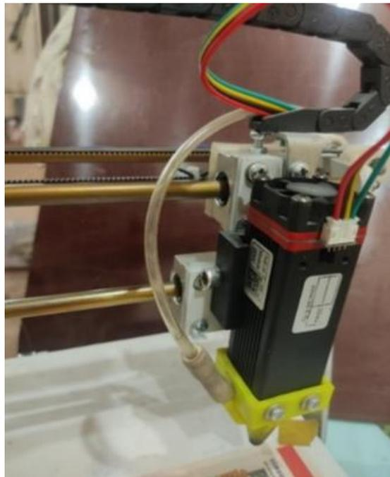
**Рис. 2. Лазерная головка**
