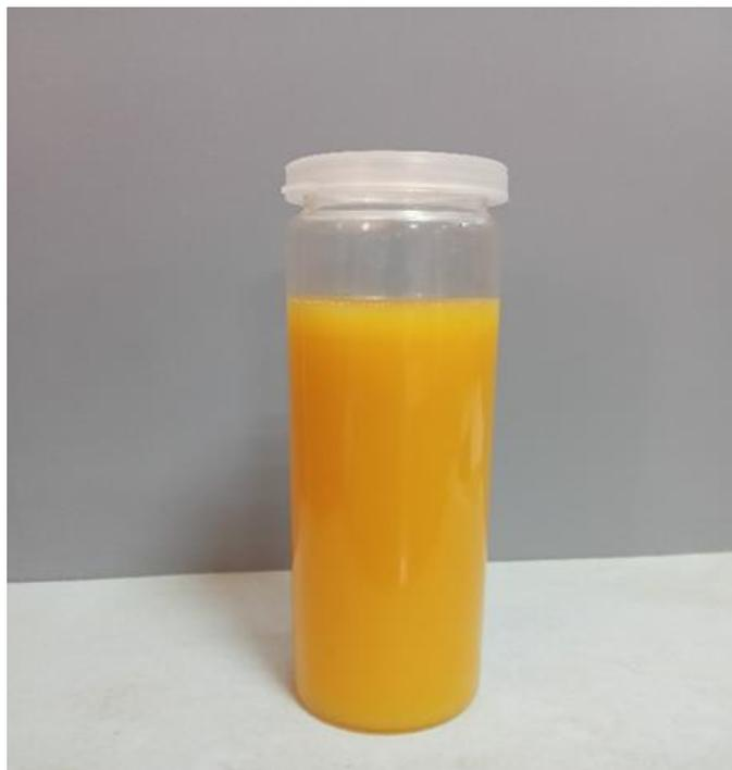
**Рис. 3 Базовое масло категории G-1 с нано измельченного фторопласта**
