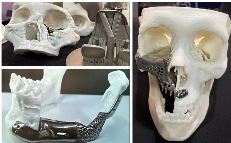
**Рис. 1. 3D модель импланта нижней челюсти и скуло-максиллярного комплекса из композитного материала**
