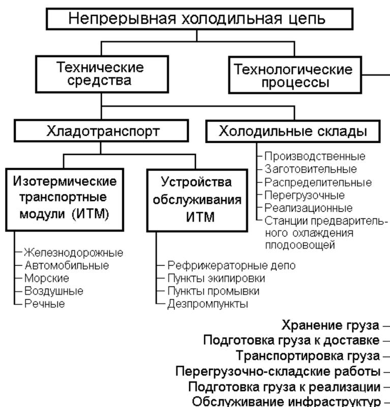
Рис. 2. Система непрерывной холодильной цепи пищевых продуктов
