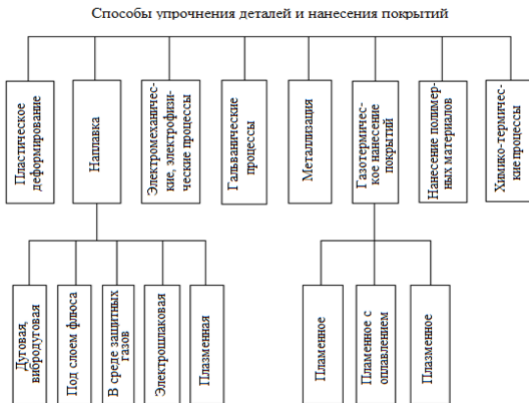
Рис. 1. Классификация способов упрочнения деталей и нанесения покрытий [3]
