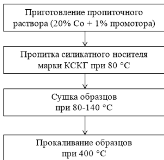
Рис. 1. Основные этапы приготовления катализаторов
