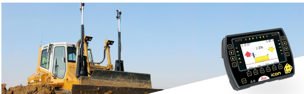
Рис. 1. Система автоматического управления на бульдозере Б-10М
