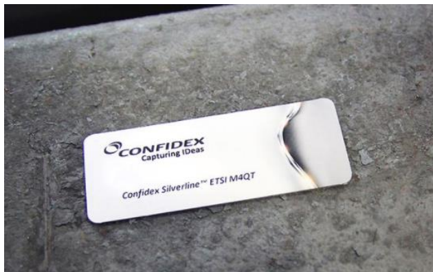
Рис. 1. RFID-метка Confidex Silverline
