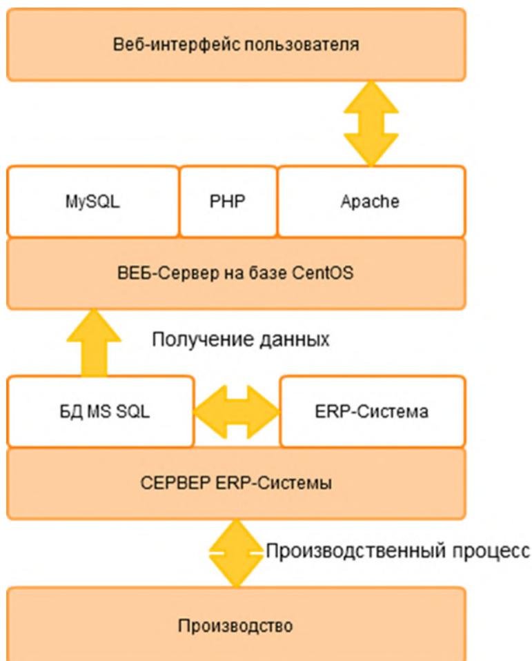
**Рис. 1. Схема выполнения запросов и обмена данными**
