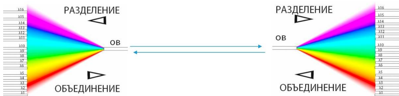
Рис. 2. Принципиальная схема работы пары CWDM фильтров на 16 длин волн. Топология: точка-точка
