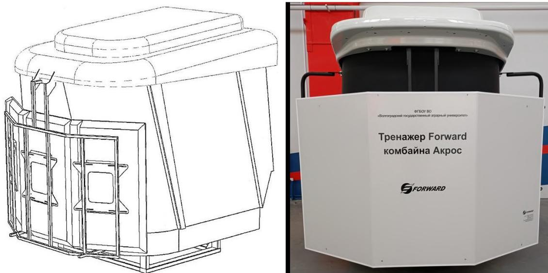
**Рис. 1. Общий вид интерактивного тренажера комбайна на основе оригинальной кабины**
