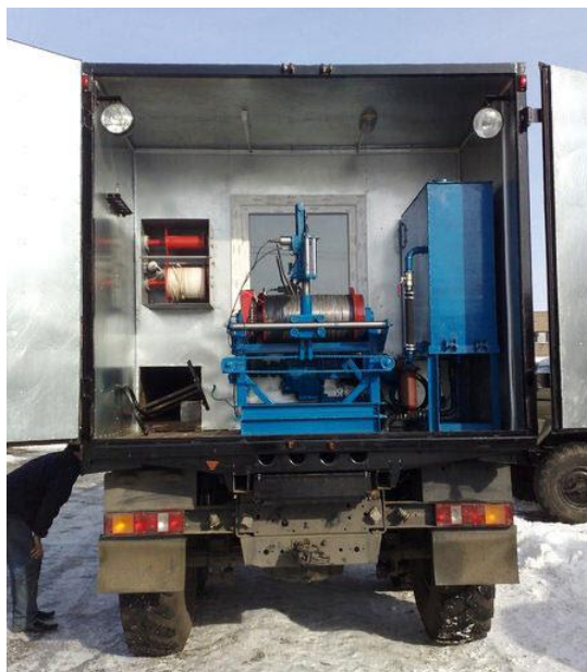
Рис. 2. Установка ЛСГ-10 на шасси автомобиля Урал (задний вид мобильной установки)
