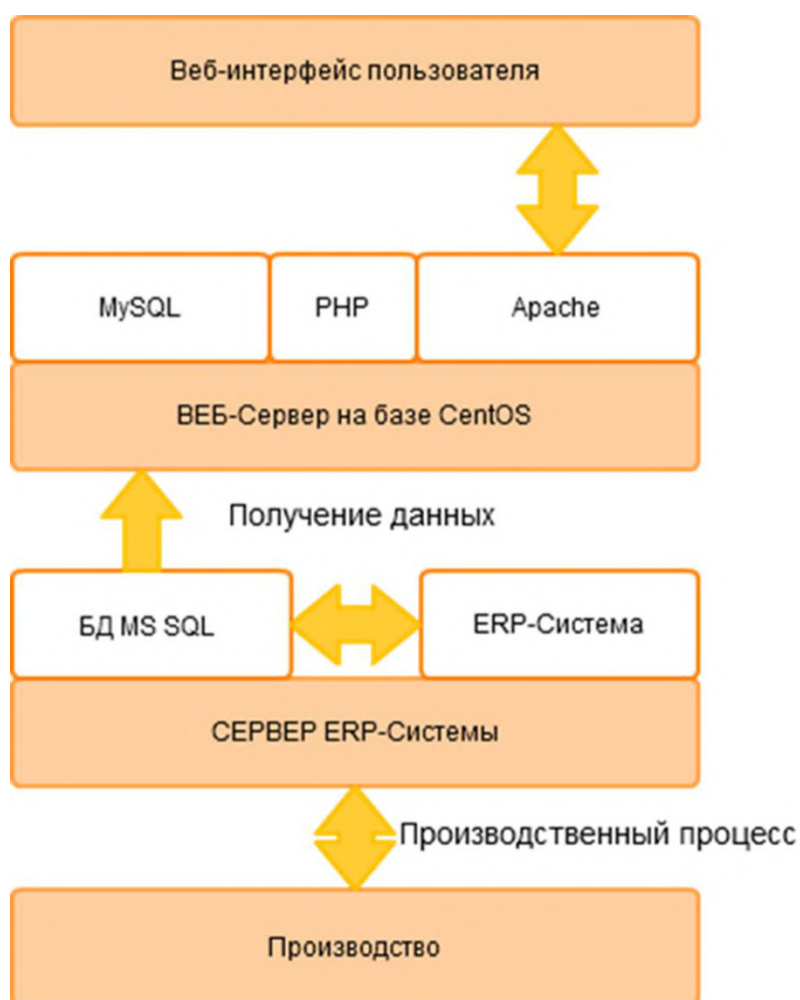
Рис. 2. Схема выполнения запросов и обмена данными
