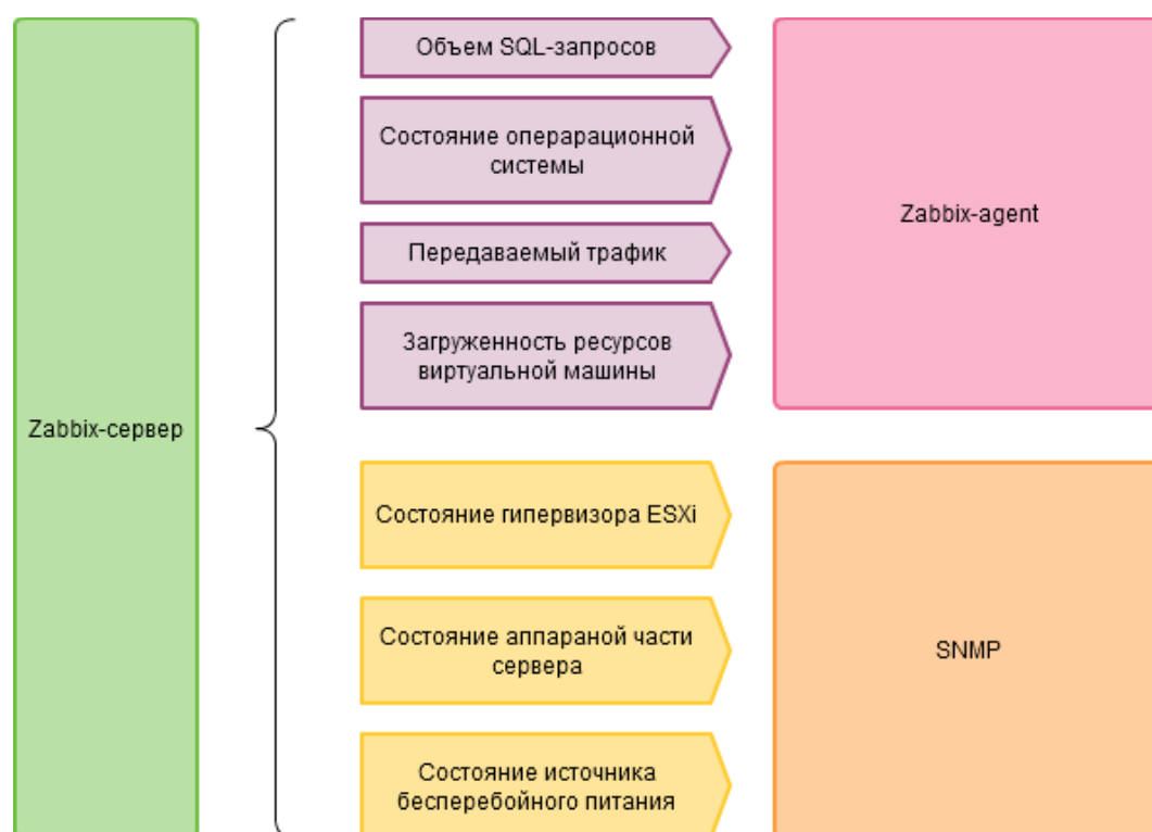
Рис. 1. Схема сбора информации Zabbix-сервером
