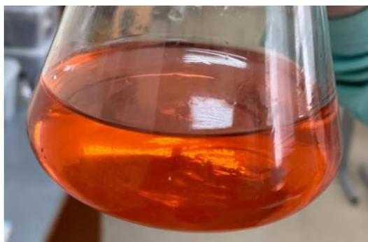
**Рис. 4. Определение устранимой жесткости**
