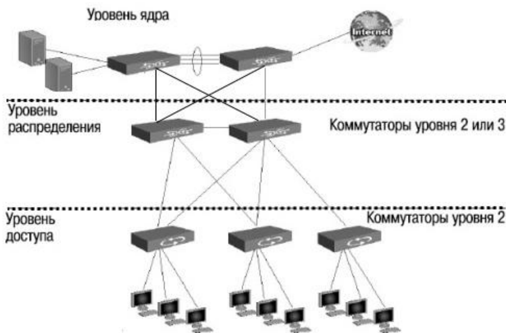
Рис. 3. Схема связи между ядром сети и оборудованием уровня доступа
