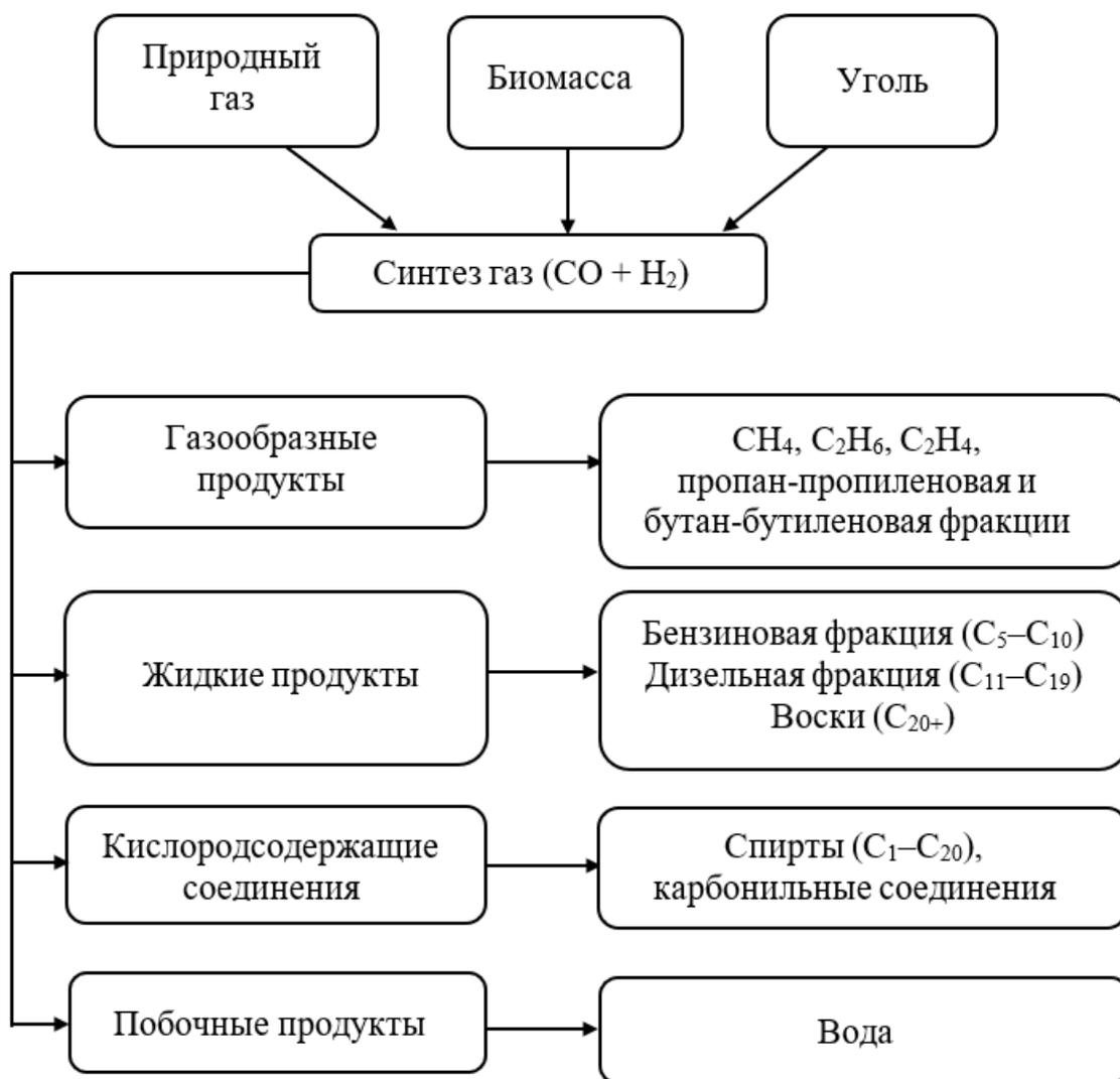
**Рис. 1. Блок-схема возможных продуктов, образующихся в результате синтеза Фишера-Тропша**
